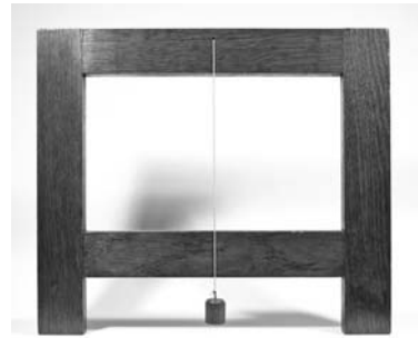
Niveau à perpendicule ou niveau de Salomon [...] DEYROLLE - Paris, présenté sur le site internet Le Compendium.
